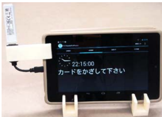
図- 1: 製作した固定具により外付けリーダーを保持
